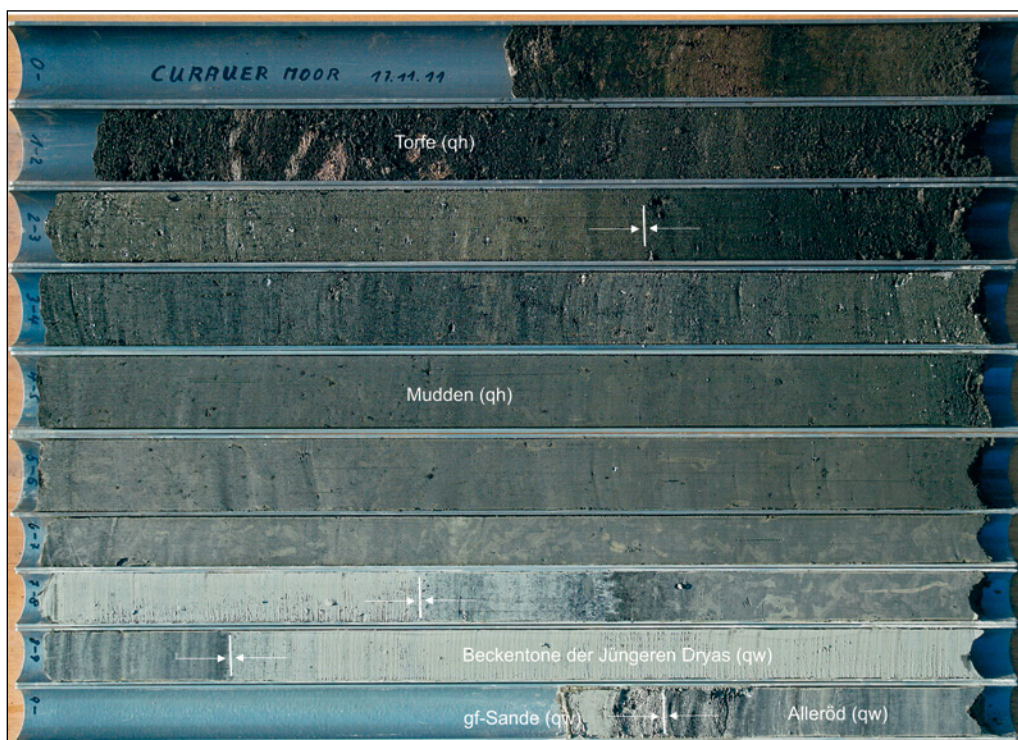
Abb. 9: Bohrkern aus dem Zentrum des Curauer Moores. Die Länge eines Bohrkernliners beträgt 1 m. Über der sandigen Basis (8,30 bis Endteufe) folgen feinkörnige Ablagerungen des Spätglazials (8,30-7,35m), mächtige feinkörnige Mudden (7,35-4,15m) sowie Grobdetritusmudden (4,15-2,30m) sowie Torfe des Holozäns.
